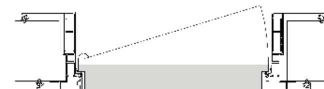
SEZIONE ORIZZONTALE PORTA A SPINGERE CON STIPITI A 45° Horizontal section push door with 45° jambs
